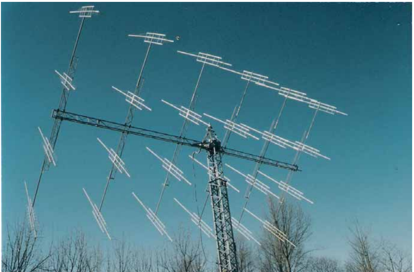
Beispiel für eine aufwändige EME-Antenne: 24 x 19 Log Loop Yagi bei I2FAK
