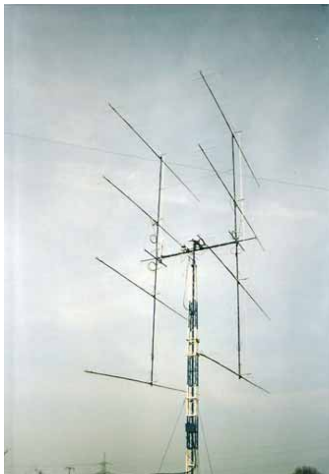
EME 2m Antenne DL5MAE bis 2006: 8 x 17 Element M 2
