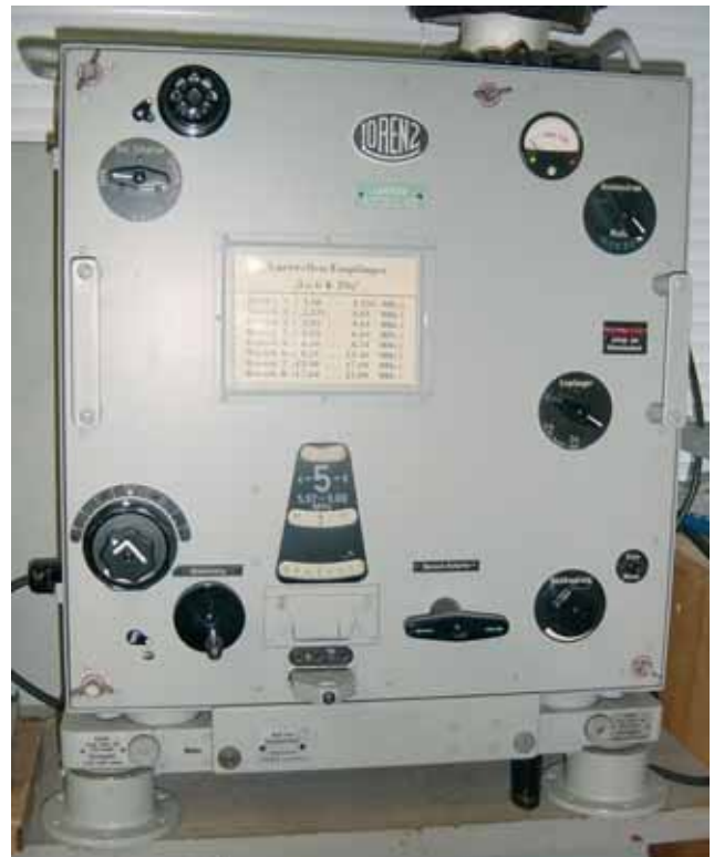
Der KW-Empfänger Lo 6 K 39a wog 60 kg
