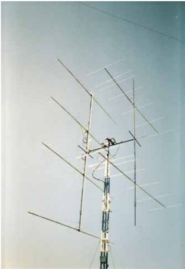
Die aktuelle EME-Antenne von DL5MAE: Eine 4 x 17 El. M 2 (2m) und eine 2 x 7 El. M 2 (6m)
