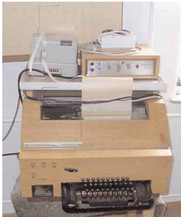
Ein Fernschreiber, wie er bis in die 70er Jahre auch von Funkamateuren verwendet wurde.
