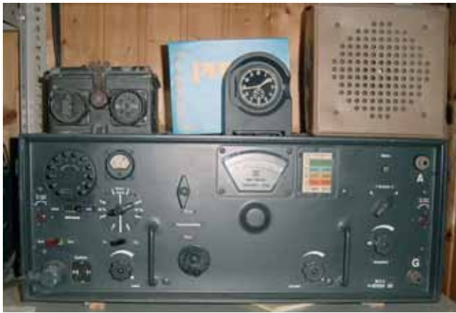
Der Kurzwellenempfänger a (Anton) besaß 11 Röhren
